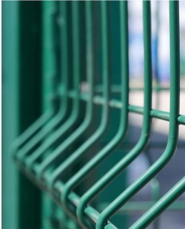
Panneau électro-soudé pour clôtures définitives avec des plis longitudinaux en « V » renforçant la rigidité, fils de 5 mm horizontaux et verticaux, maille de 200x50 mm, renforcement 50x50 mm, picot défensif sur la partie supérieure d'une hauteur de 30 mm
