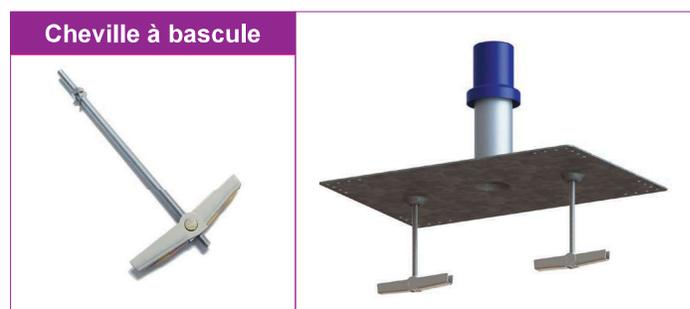
La cheville à bascule est maintenue par un élastique et se déploie automatiquement pour assurer la fixation.
